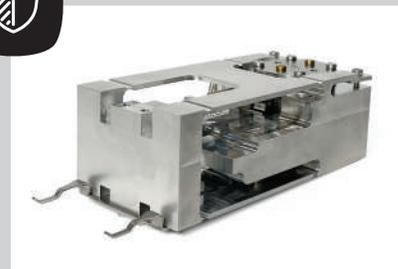
Весы серии ВЛК работают на основе принципа электромагнитной компенсации с применением моноблочной водоизмерительной ячейки, обеспечивающей минимальное количество разъемных соединений между весовой чашей и чувствительными элементами сенсора, что обеспечивает минимизацию постепенно накапливающихся механических факторов, способных влиять на увеличение погрешности прибора.
