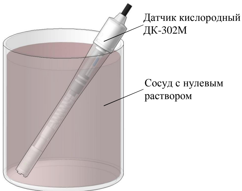
Рисунок 2.11 – Проверка показаний в «нулевом» растворе
