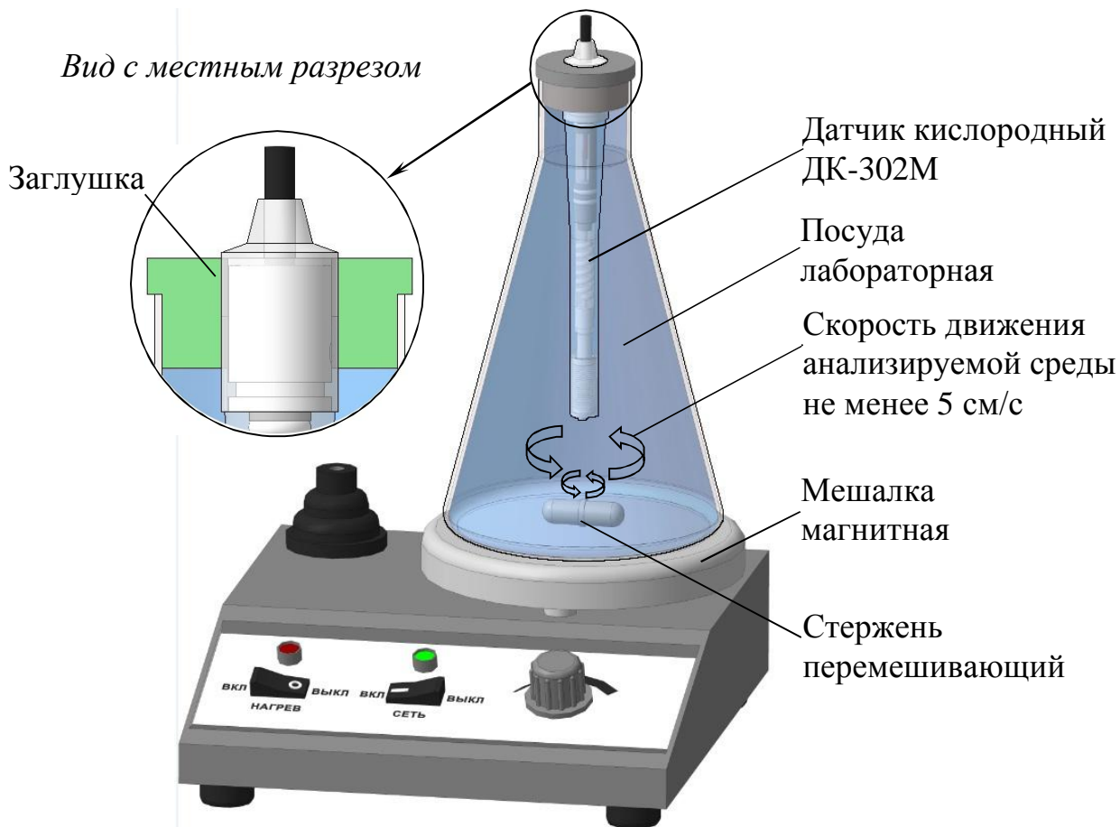
Рисунок 2.31 - Положение датчика в лабораторной посуде при измерении КРК (УНК)
