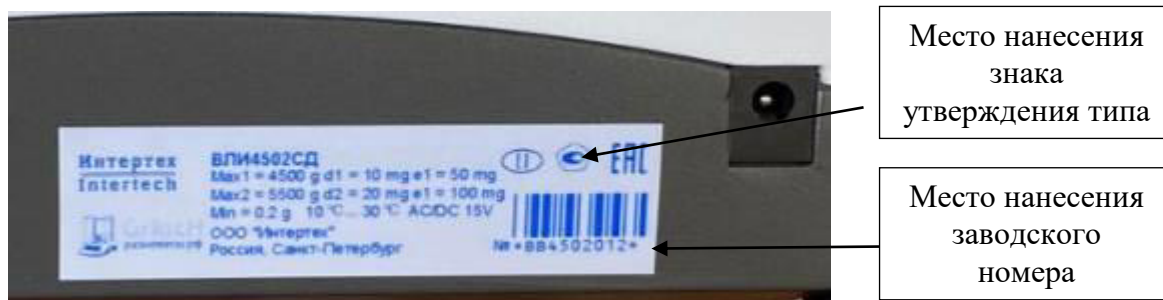
Рисунок 2 – Место нанесения знака утверждения типа и заводского номера
