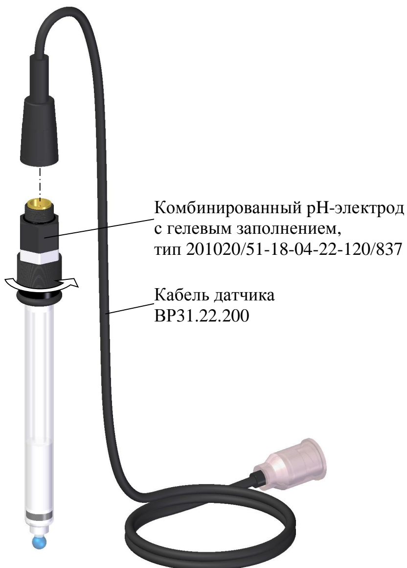
Рисунок 2.3 – Подсоединение кабеля датчика к электроду
