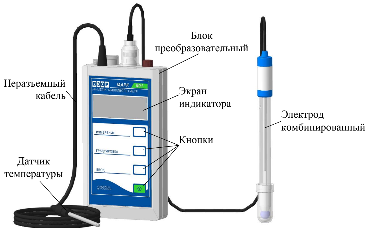
а) pH-метр/милливольтметр портативный МАРК-901
