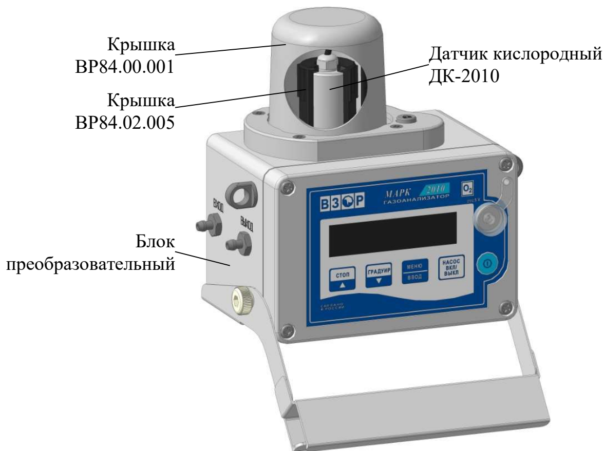
Рисунок 1.1 – Газоанализатор МАРК-2010 (вид с местным разрезом)
