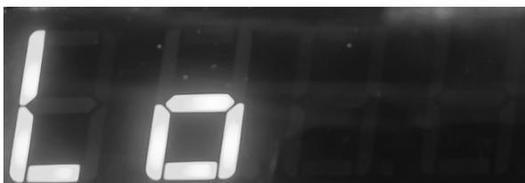
Рисунок 2.1 – Сигнал «Lo», низкая температура
