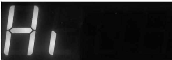
Рисунок 2.2 – Сигнал «Hi», высокая температура
