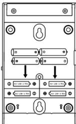
Установите на место крышку аккумуляторного отсека и затяните винты. Подсоедините принтер к весам и включите выключатель питания принтера. Состояние батареи отображается в верхнем левом углу дисплея.
