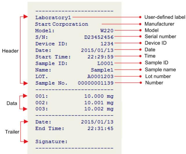
Принтер позволяет пользователю задавать стили заголовка, данных и нижнего колонтитула в отчете, позволяет включать и
